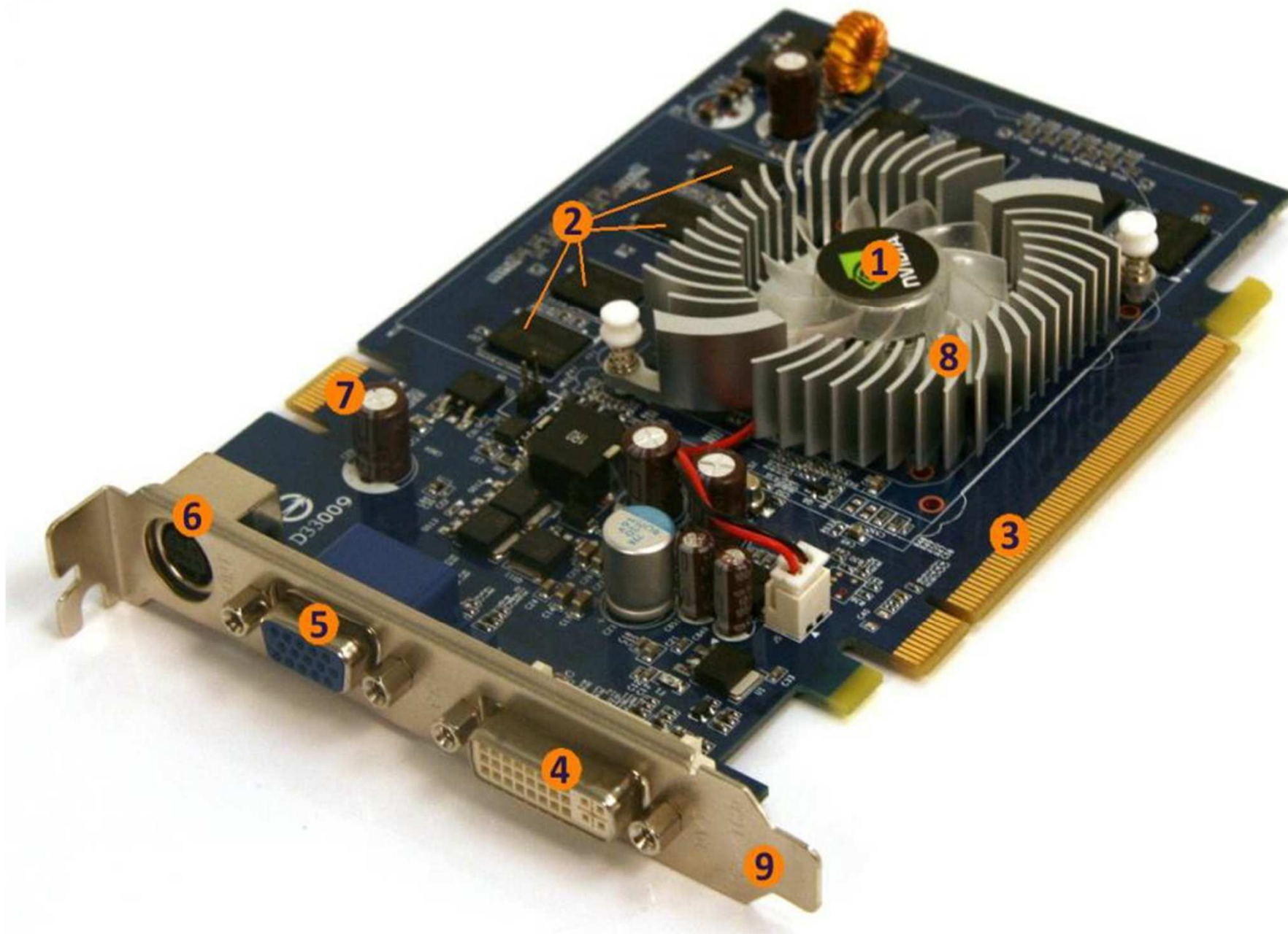
1 - układ GPU (pod chłodzeniem), 2 - kości pamięci RAM, 3 - złącze PCI-E 16x, 4 - wyjście DVI, 5 - wyjście D-SUB, 6 - wyjście S-Video, 7 - złącze SLI, 8 - chłodzenie , 9 - śledź montażowy
